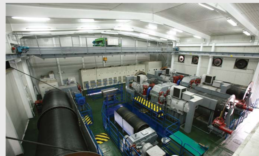
Две независимые системы подъема Two independent hoisting system sets
