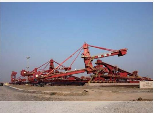
4 единицы стакер-реклаймеров с производительностью 4200 т/ч и поворотным радиусом 45 м
