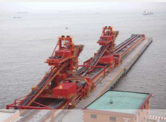
2 единицы судопогрузчиков с производительностью 4200 т/ч для реализации функции перегрузки по схеме вода-вода
